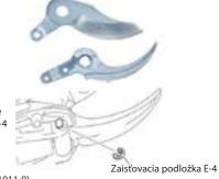
So zaisťovacou podložkou E-4 (obj.č. 961011-9) Potrebné objednať skrutky M3x6 obj. č. 266183-8 a M8 251573-8
