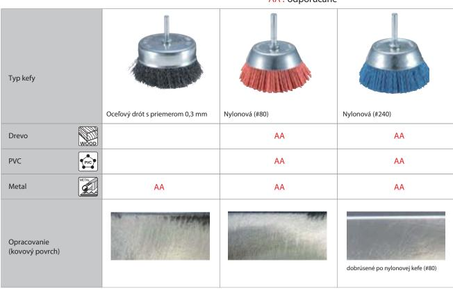
Oblasti využitia kief z oceľového drôtu: odstraňovanie lakov, okovín, hrdze, trosky, odstraňovanie zbytkov betónu a tmelov/stierky zahladzovanie a začisťovanie zvarov, príprava kovových povrchov pred lakovaním. Mimoriadne prednosti: vysoká tuhosť drôtených vretien, vďaka tomu majú kefy vysoký úberový výkon, húževnatosť, veľmi vysoká pevnosť v ťahu umožňuje vysoké otáčky. Kužeľovitý tvar kefy uľahčuje kefovanie na ťažko prístupných miestach (vnútorné hrany, ryhy, drážky).
